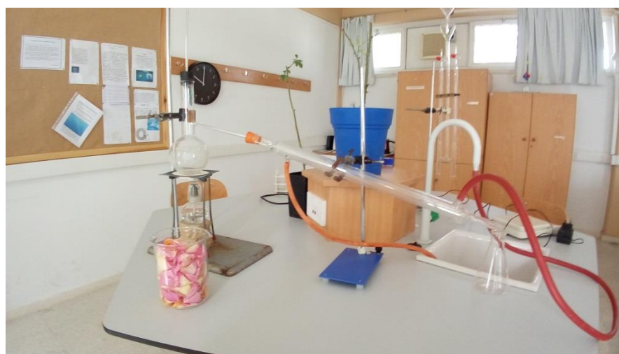
Συσκευή απόσταξης με πλάγιο ψυκτήρα
