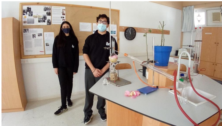
Παραγωγή ροδοστάγματος με συσκευή απόσταξης με πλάγιο ψυκτήρα
