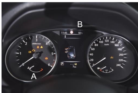
▲ Εικόνα 4.10 Ένδειξη της θερμοκρασίας της μηχανής (A) και της θερμοκρασίας περιβάλλοντος (B) σε ένα αυτοκίνητο.
