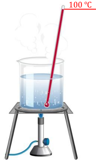
▲ Εικόνα 4.42 Λεπτός σωλήνας με οινόπνευμα σε νερό που βράζει.
