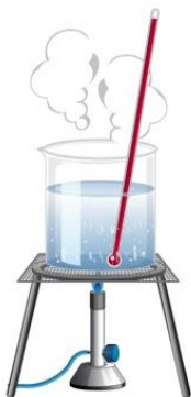
▲ Εικόνα 4.26 Όταν η θερμοκρασία του νερού γίνει 100 °C, καθώς συνεχίζεται η μεταφορά θερμότητας, το νερό μετατρέπεται σταδιακά σε υδρατμό.
