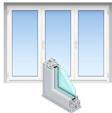
▲ Εικόνα 5.16 Διπλά τζάμια με δύο υαλοπίνακες, ανάμεσα στους οποίους υπάρχει διαφανές μονωτικό υλικό.
