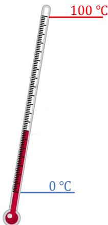
▲ Εικόνα 4.40 Βαθμονομημένο θερμόμετρο οινόπνευματος.
