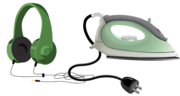
▲ Εικόνα 3.6 Ηλεκτρικές συσκευές με καλώδιο διαφορετικού εμβαδού διατομής.
