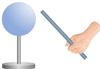
▲ Εικόνα 2.46(β) Ηλεκτρικά φορτισμένη μεταλλική σφαίρα και γυάλινη ράβδος μετά τη μεταξύ τους επαφή που φαίνεται στην εικόνα 2.46(α).
