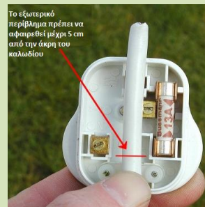
Εικόνα 1- 41: Αφαίρεση εξωτερικού περιβλήματος καλωδίου
