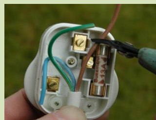
Εικόνα 1- 42: Τα καλώδια αποκόπτονται στο σωστό μέγεθος
