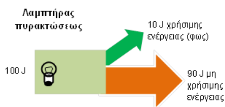
Εικόνα 1- 26: Ενεργειακό διάγραμμα λαμπτήρα πυρακτώσεως
