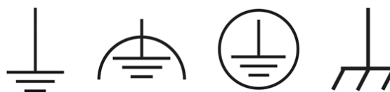
Εικόνα 1- 37: Σύμβολα γείωσης ηλεκτρικής συσκευής
