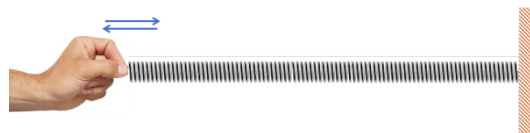
Εικόνα 2- 10: Σχηματισμός διαμήκους κύματος σε ελατήριο
