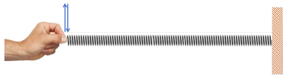
Εικόνα 2- 4: Δημιουργία εγκάρσιου κύματος σε ελατήριο
