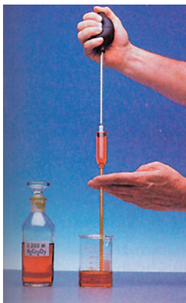
Το σιφώνιο χρησιμοποιείται για τη μέτρηση και μεταφορά ορισμένου όγκου υγρών
