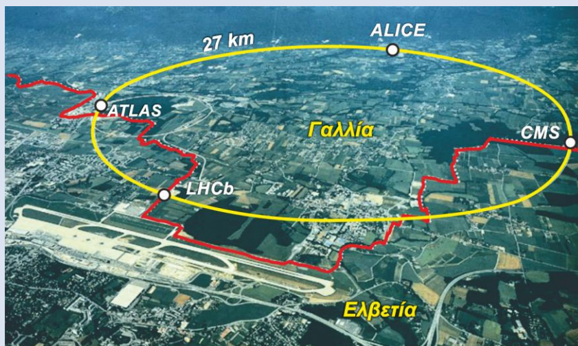
Εικόνα 4-52: Ο δακτύλιος διαμέτρου 27 km του LHC διέρχεται μέσα από τα Γάλλο-Ελβετικά σύνορα. Στο κάτω αριστερό μέρος της φωτογραφίας, διακρίνεται ο δίαυλος του αεροδρομίου της Γενεύης.
