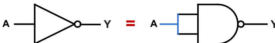
Σχ. 2/104 Ο αναστροφέας NOT ισοδυναμεί με μία λογική πύλη NAND, της οποίας οι δύο εισόδοι είναι ενωμένες μαζί
