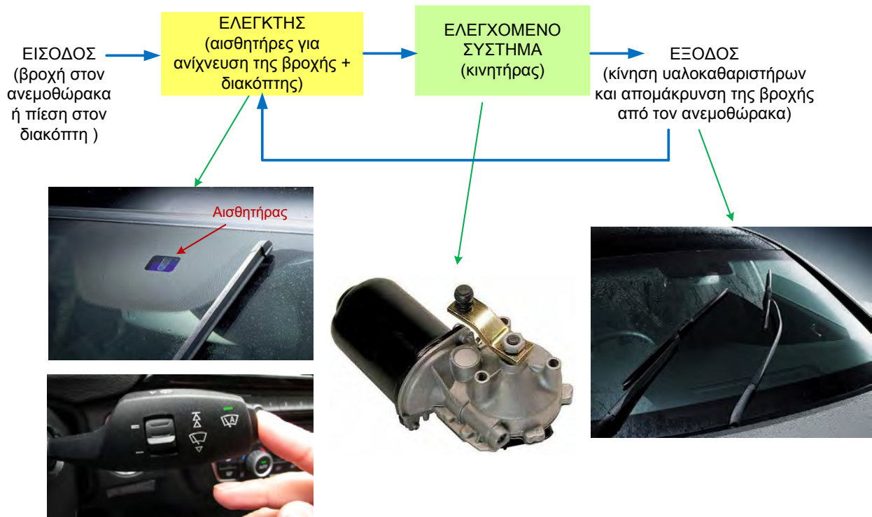
Σχ. 4/9 Υαλοκαθαριστήρες αυτοκινήτου με χειροκίνητο και αυτόματο έλεγχο.
