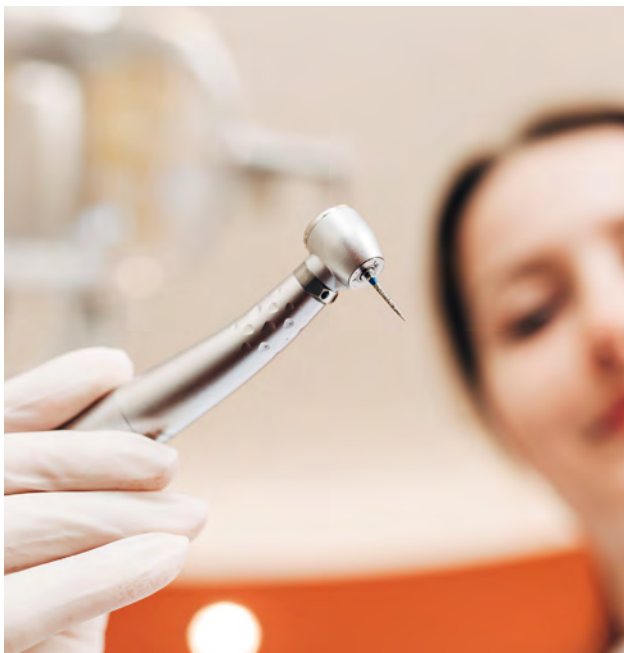
Σχ. 5/7 Τρυπανάκια οδοντιάτρων στα οποία χρησιμοποιείται πιεσμένος αέρας για την περιστροφή τους
