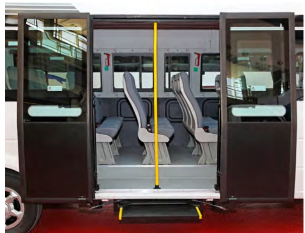
Σχ.5/45 Θύρα λεωφορείου που ελέγχεται από πνευματικό σύστημα
