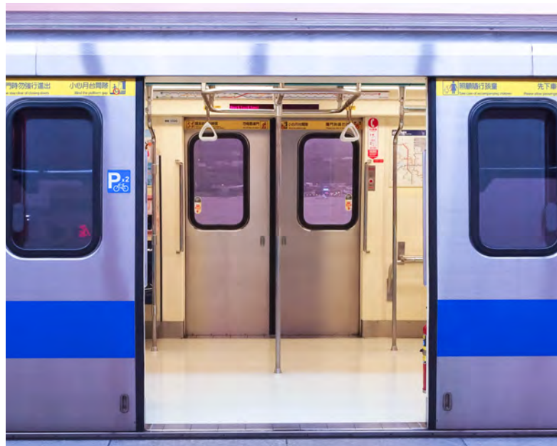
Σχ. 5/8 Οι θύρες σε αμαξοστοιχία ανοιγοκλείνουν με χρήση πιεσμένου αέρα
