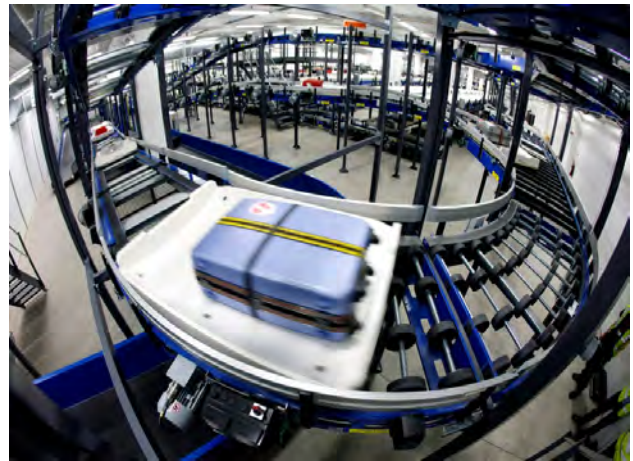
Σχ. 4/1 Αυτόματο σύστημα μεταφοράς και διανομής αποσκευών σε ένα αεροδρόμιο
