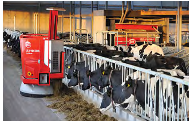
Σχ. 4/4 Ρομποτικό μηχάνημα τσίματος αγελάδων σε φάρμα
