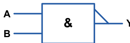
Σχ. 2/85 Νέο σύμβολο λογικής πύλης NAND δύο εισόδων
