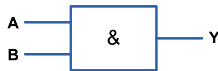
Σχ. 2/72 Νέο σύμβολο λογικής πύλης AND δύο εισόδων
