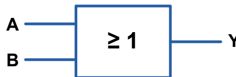
Σχ. 2/76 Νέο σύμβολο λογικής πύλης OR δύο εισόδων
