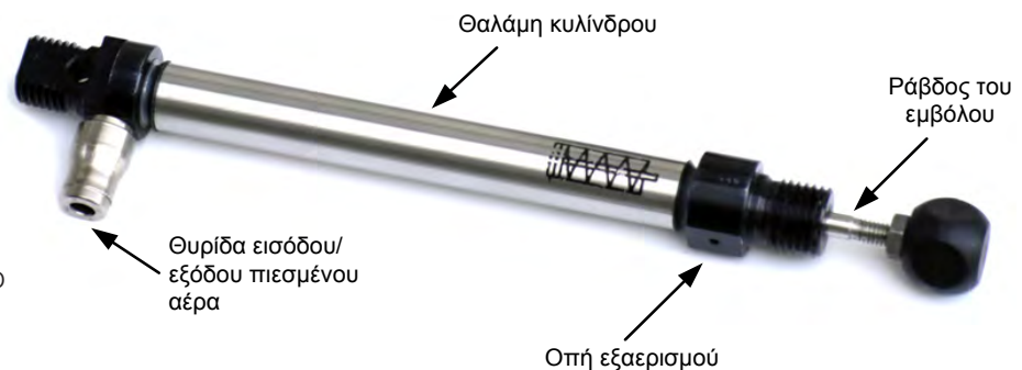
Σχ. 5/26 Κύλινδρος απλής ενέργειας με ελατήριο επαναφοράς
