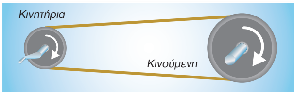
Μετάδοση κίνησης με μείωση της ταχύτητας
