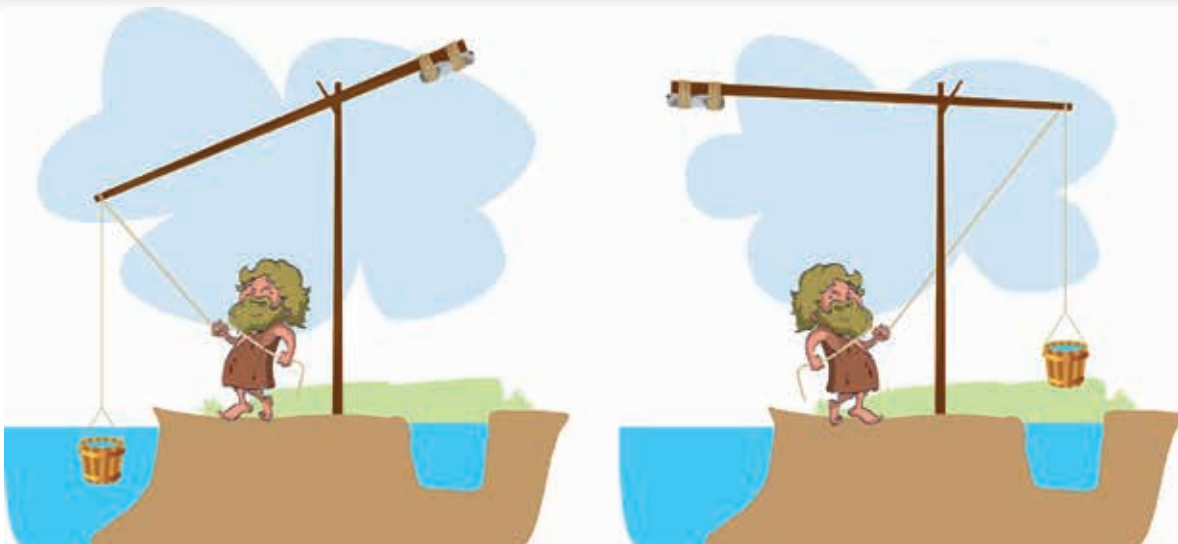
Σαντούφ Μηχανή με χρήση μοχλών για διοχέτευση νερού σε καλλιέργειες
