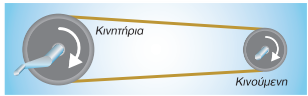
Μετάδοση κίνησης με αύξηση της ταχύτητας
