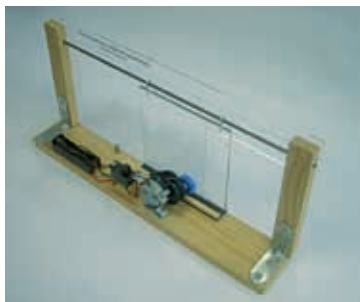
Εποπτικό μέσο που χρησιμοποιεί οδοντωτό κανόνα και οδοντοτροχό
