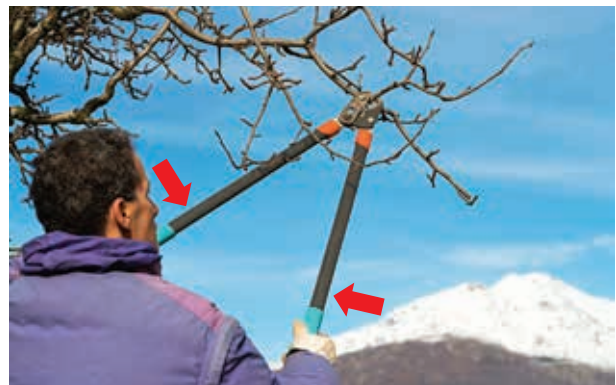
Ψαλίδι που κόβει χοντρούς κλάδους έχει πολύ μεγάλα κερούλια και μικρές σιαγόνες.
