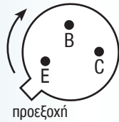
Αναγνώριση ακροδεκτών τρανζίστορ BFY51 και BC108 (και BC109)
