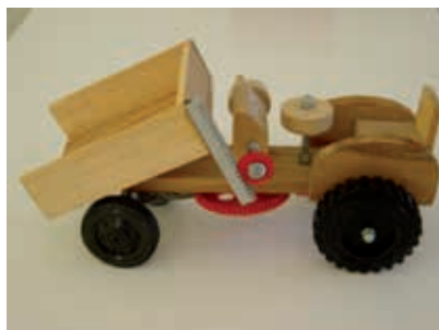
Έργο μαθητή που χρησιμοποιεί οδοντωτό κανόνα και οδοντοτροχό
