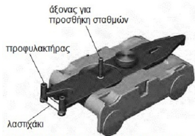
Εικόνα 7α: Η πάνω όψη του αμαξιδίου με τον ελαστικό προφυλακτήρα.
