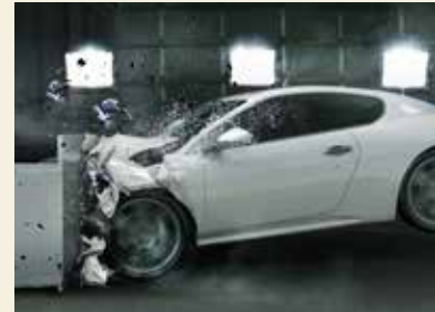
Παραμόρφωση του μπροστινού μέρους αυτοκινήτου σε έλεγχο σύγκρουσης (crash test).
