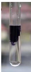
Εικόνα 4. Χρώμα φαινολικού συμπλόκου που σχηματίζεται κατά την αντίδραση φαινολικής ένωση και χλωριούχου σιδήρου(III). [15]
