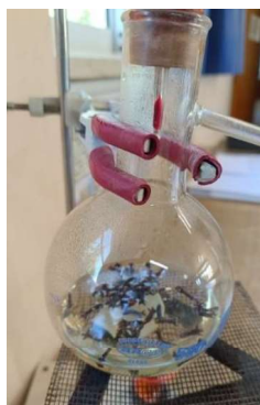
Εικόνα 5. Πάνω αριστερά: Γαρύφαλλα, Πάνω δεξιά: σφαιρική φιάλη απόσταξης με το μίγμα αποσταγμένου νερού και γαρύφαλλων. Κάτω: Συσκευή απόσταξης ευγενόλης.
