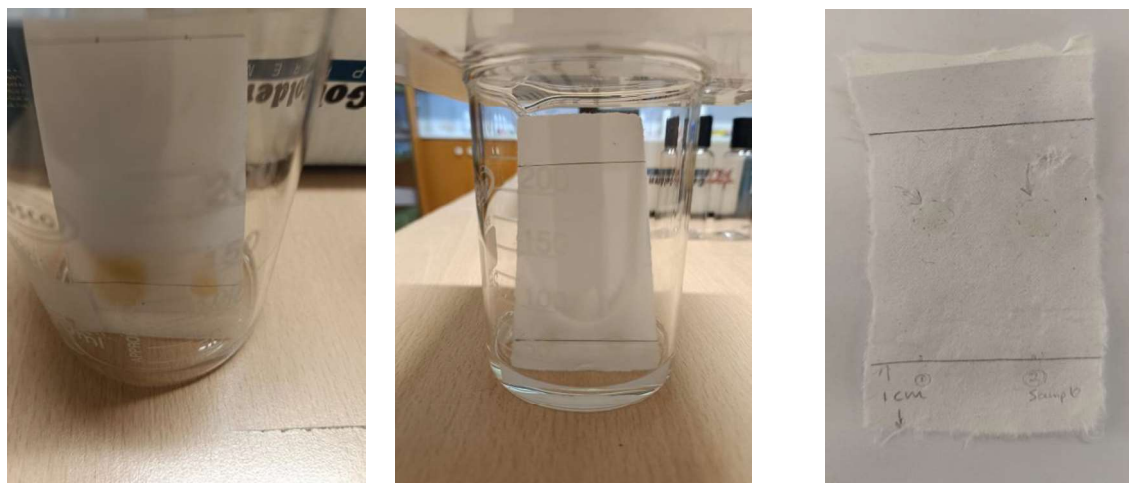
Εικόνα 12. Πορεία χρωματογραφίας λεπτής στιβάδας. Τοποθέτηση των κηλίδων στο διηθητικό χαρτί της παραγόμενης ευγενόλης (δείγμα- sample) και της ευγενόλης του εμπορίου, ανάπτυξη διαλύτη και έλεγχος ταυτοποίησης του δείγματος.
