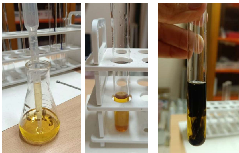
Εικόνα 13. Ανίχνευση της φαινολικής ομάδας της ευγενόλης με διάλυμα χλωριούχου σιδήρου (III), \text{FeCl}_3
