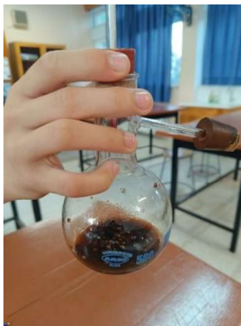
Εικόνα 9. Αριστερά: Εκχύλιση μίγματος ευγενόλης-αιθανόλης και νερού, δεξιά: Τελικό μίγμα στη φιάλη απόσταξης που περιέχει ευγενόλη και αιθανόλη.
