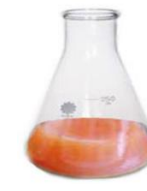
Δείγμα στο οποίο έχει ξεπεραστεί το τελικό σημείο
