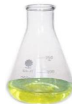
Δείγμα νερού με δείκτη \text{K}_2\text{CrO}_4
