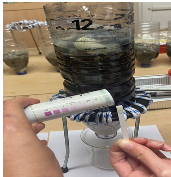
Εικόνα 7: ΤΟ ΦΙΛΤΡΟ ΑΠΟΜΑΚΡΥΝΕ ΟΛΟ ΤΟ ΥΠΟΛΕΙΜΜΑΤΙΚΟ ΧΛΩΡΙΟ ΑΠΟ ΤΟ ΝΕΡΟ, ΕΝΔΕΙΞΗ 0 mg/L
