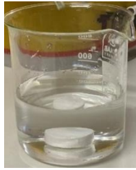
Εικόνα 5 ΤΑΜΠΛΕΤΑ ΧΛΩΡΙΟΥ, ΥΠΟΧΛΩΡΙΩΔΕΣ ΑΣΒΕΣΤΙΟ ΜΕΣΑ ΣΕ 500 ML ΑΠΟΣΤΑΓΜΕΝΟ ΝΕΡΟ
