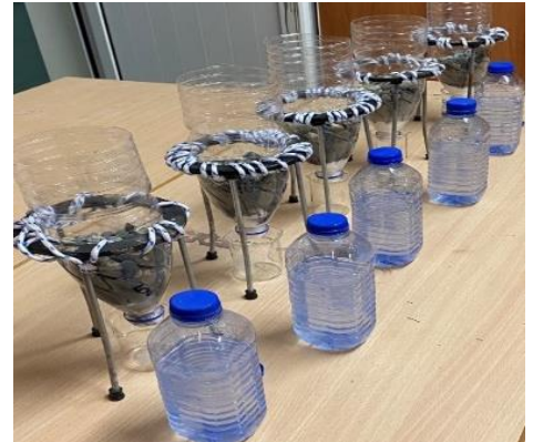
Εικόνα 7 ΠΡΟΣΤΕΘΗΚΕ Η ΙΔΙΑ ΠΟΣΟΤΗΤΑ ΥΔΑΤΙΚΟΥ ΔΙΑΛΥΜΑΤΟΣ ΕΛΕΥΘΕΡΟΥ ΧΛΩΡΙΟΥ ΣΕ ΟΛΑ ΤΑ ΦΙΛΤΡΑ
