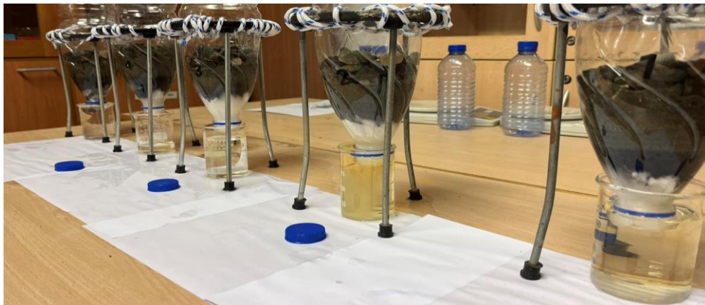
Εικόνα 6 ΤΟΠΟΘΕΤΗΘΗΚΑΝ ΤΑ ΦΙΛΤΡΑ ΠΑΝΩ ΣΕ ΛΕΥΚΕΣ ΚΟΛΛΕΣ ΓΙΑ ΝΑ ΔΙΑΚΡΙΝΕΤΑΙ ΟΡΘΑ ΤΟ ΧΡΩΜΑ ΚΑΙ Η ΔΙΑΥΓΕΙΑ ΤΟΥ ΦΙΛΤΡΑΡΙΣΜΕΝΟΥ ΝΕΡΟΥ
