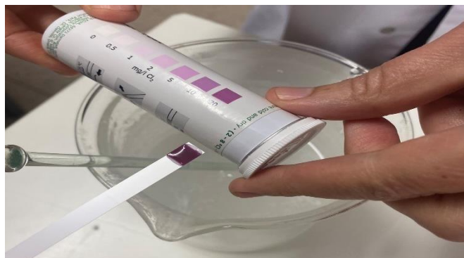
Εικόνα 4 ΑΡΧΙΚΗ ΣΥΓΚΕΝΤΡΩΣΗ ΧΛΩΡΙΟΥ ΣΤΟ ΔΙΑΛΥΜΑ ΠΡΙΝ ΠΕΡΑΣΕΙ ΑΠΟ ΤΑ ΦΙΛΤΡΑ > 20 mg/L
