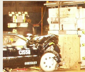
Παραμόρφωση του μπροστινού μέρους αυτοκινήτου σε έλεγχο σύγκρουσης (crash test).
