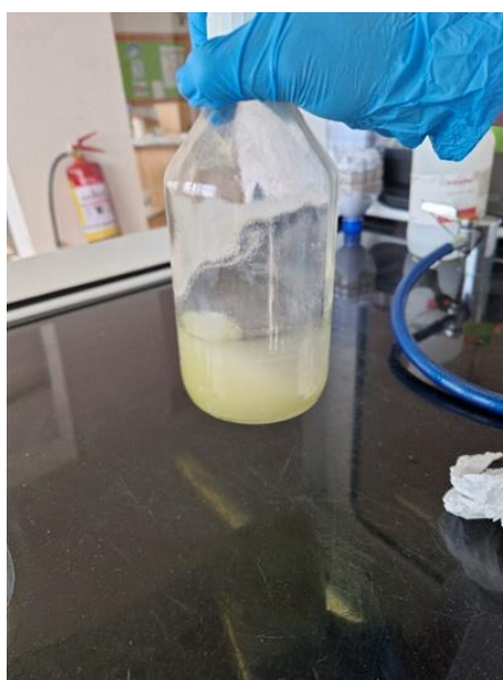
Ζέσταμα του λαδιού στους 55 °C και μεταφορά του στο μείγμα αιθανόλης- NaOH
