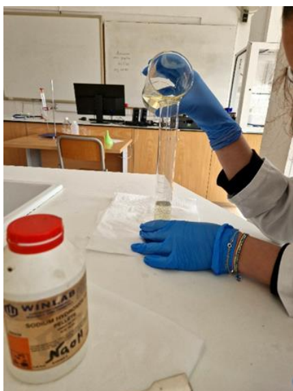
Μέτρηση του όγκου του τηγανελαίου με ογκομετρικό κύλινδρο και σούρωμα αυτού
