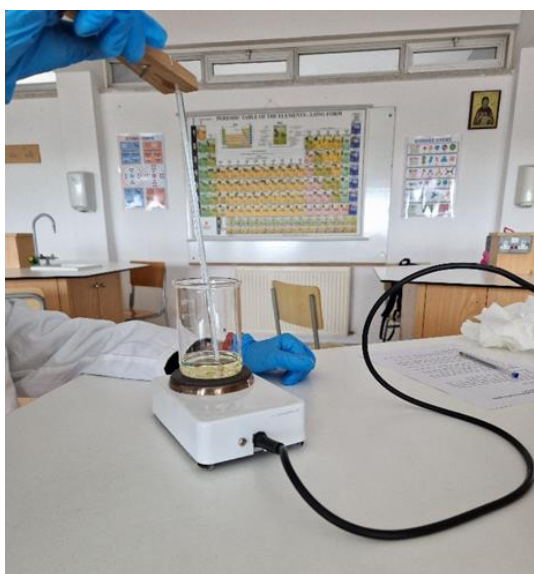
Ζέσταμα του λαδιού στους 55 °C και μεταφορά του στο μείγμα αιθανόλης- NaOH
