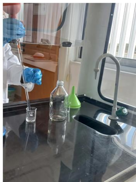
Μέτρηση του όγκου της μεθανόλης με σιφώνιο
