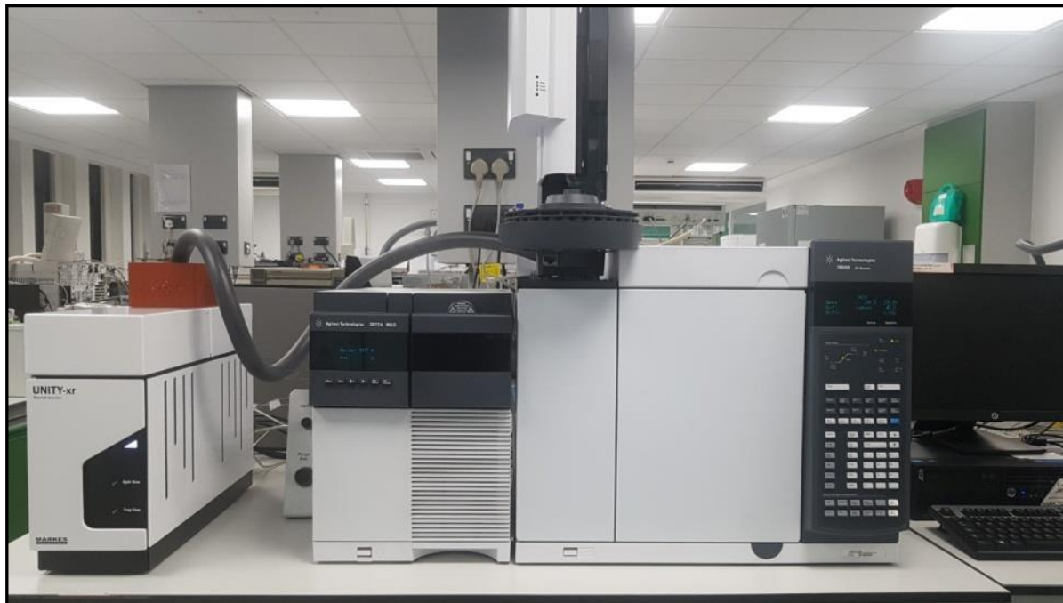
Φωτογραφία 5. Αέριος χρωματογράφος από το αναλυτικό εργαστήριο Χημείας στο Loughborough University στην Αγγλία.
