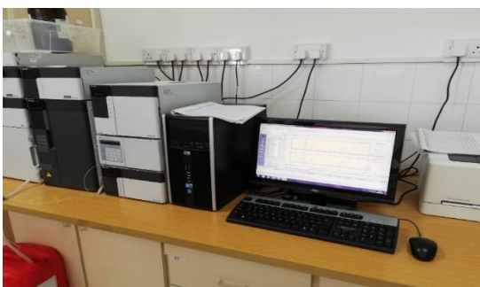
Ποσοτική ανάλυση αιθανόλης στο εργαστήριο του Τμήματος Γεωργίας(Κλάδος Αμπελουργίας και Οινοποιίας) με τη μέθοδο απόσταξης σε ηλεκτρονικό πυκνόμετρο με μεγάλη ακρίβεια στους 20 °C
