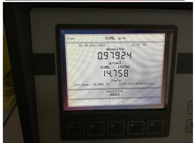
Ποσοτική ανάλυση αιθανόλης στο εργαστήριο του Τμήματος Γεωργίας(Κλάδος Αμπελουργίας και Οινοποιίας) με τη μέθοδο απόσταξης σε ηλεκτρονικό πυκνόμετρο με μεγάλη ακρίβεια στους 20 °C
