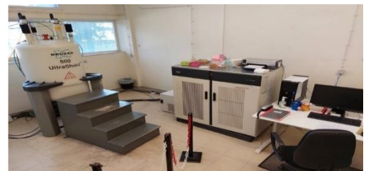
Εικόνα 2: Φασματογράφος 500 MHz εγκατεστημένος στο Τμήμα Χημείας του Εθνικού Καποδιστριακού Πανεπιστημίου Αθηνών. Είναι άρτια εξοπλισμένος για εκτέλεση πειραμάτων μεταβολικής.
