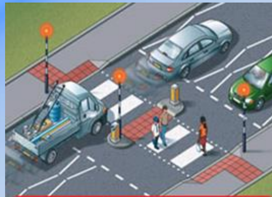
Φώτα και νησίδα στη μέση για διπλή διασταύρωση
