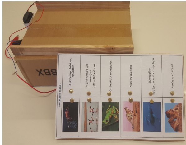
Βάση από χαρτόνι από χαρτόκουτο, λωρίδα κόριφλουτ συγκρατεί φύλλο, συνδέσεις καλωδίων πάνω στο φύλλο , εναλλακτικά φύλλα (με διάφορα θέματα)
