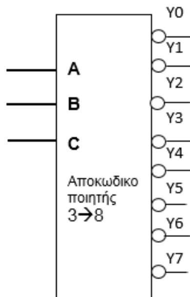
Λογικό σύμβολο αποκωδικοποιητή 3 σε 8
